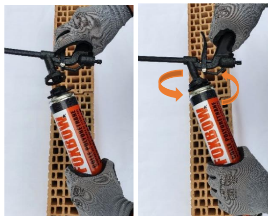
3. Visser le pistolet applicateur et régler le débit à l'arrière du pistolet
