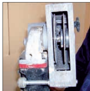
Speciale sleuvenfrees met 2 diamantdoorslijpschijven en verstelbare snijbreedte en -diepte.
